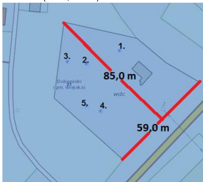
Ryc.10 Otwory hydrogeologiczne na terenie wodociągów wykonane w latach 70-tych i 1987 odwiert 4 (1A), granica działki stanowi strefę ochronną Kolor czerwony oznacza wymiary strefy ochronnej ustalonej Decyzją z dnia 05.10.2000 r.
